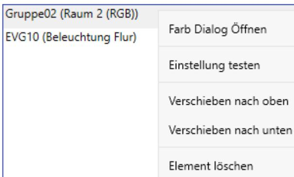
Dazu wird eine Verbindung zum DaliControl e64 Pro benötigt. Der Befehl mit der Einstellung des Wertes und der Farbe wird für diese Gruppe oder EVG ausgeführt. So kann die gewünschte Eigenschaft vor dem Programmieren des gesamten Effektes kontrolliert werden. Falls die Eigenschaften „Wert beibehalten“ oder „Farbe beibehalten“ gesetzt sind, werden die entsprechenden Werte nicht aktiviert, sondern auf dem aktuellen Wert beibehalten.
