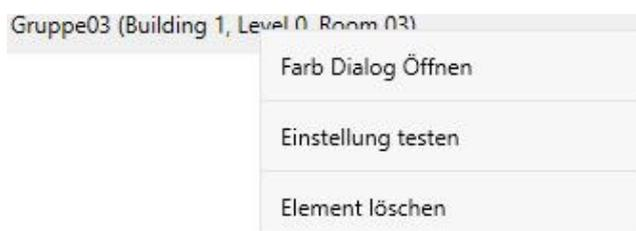
Dazu wird eine Verbindung zum DaliControl e64 Pro benötigt. Der Befehl mit der Einstellung des Wertes und der Farbe wird für diese Gruppe ausgeführt. So kann die gewünschte Eigenschaft vor dem Programmieren der gesamten Szene kontrolliert werden. Falls die Eigenschaften „Wert beibehalten“ oder „Farbe beibehalten“ gesetzt sind, werden die entsprechenden Werte nicht aktiviert, sondern auf dem aktuellen Wert beibehalten.
