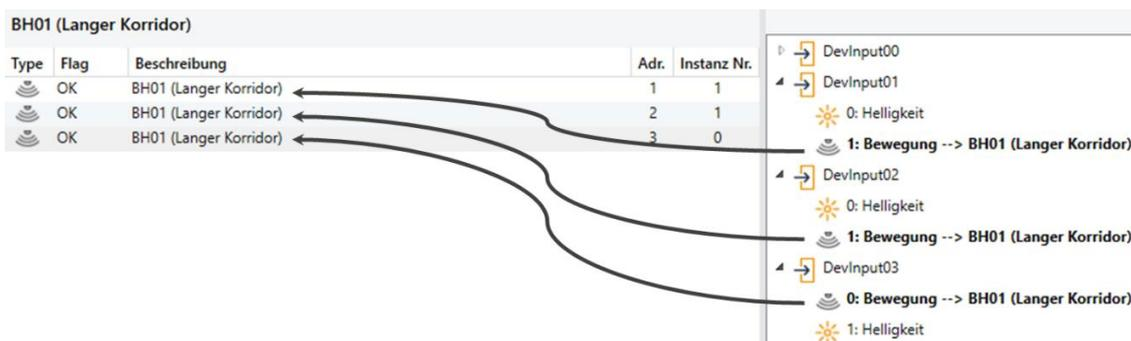
In diesem Beispiel werden 3 Instanzen von 3 verschiedenen realen Bewegungsmeldern mit einem ETS Bewegungsmelder verbunden. Dies führt dazu, dass der ETS-Bewegungsmelder immer dann ausgelöst wird, wenn eine der 3 Instanzen der realen Geräte eine Bewegung erkennt.
