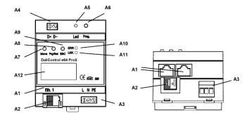
A1: RJ-45 Buchse für Ethernet Anschluss
