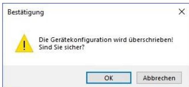
Danach werden alle DALI relevanten Daten aus der ETS in das Gerät geschrieben.
