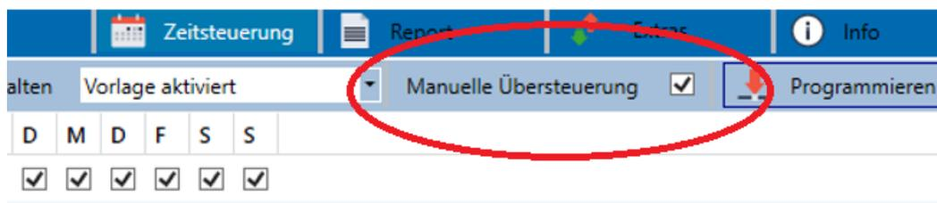
Diese Funktion ist besonders interessant für HCL Steuerungen. Wird die Helligkeit oder Farbe eines Elements (Gruppe / Einzel-EVG) geändert, stoppt der Automatikbetrieb für diese Element. Beim nächsten Aktionszeitpunkt wird dann keine automatische Farbeinstellung ausgeführt. Die Änderung, die durch den Nutzer vorgenommen wurde, bleibt solange erhalten, bis der Automatikbetrieb wieder aktiviert wird.
