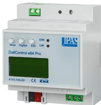
Das Gerät wandelt Schalt- und Dimmbefehle vom angeschlossenen KNX System in entsprechende DALI Telegramme, bzw. Status- und Ereignisinformationen vom DALI Bus in KNX Telegramme um.
