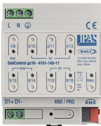
DaliControl gc16 - KNX DALI Gateway: Ansteuerung von 64 EVGs und DT-8 Farbsteuerung. Netzteil zur Versorgung der DALI EVGs integriert. Einzelansteuerung von EVGs oder Ansteuerung der EVGs in je 16 Gruppen. Inbetriebnahme über ETS-App (DCA). 16 Lichtszenen und 16 Zeitprogramme mit max. 500
