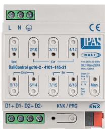
DaliControl gc16-2 - KNX DALI Gateway: Ansteuerung von 2x 64 EVGs (2 DALI Kanäle) und DT-8 Farbsteuerung. Netzteil zur Versorgung der DALI EVGs integriert. Einzelansteuerung von EVGs oder Ansteuerung der EVGs in je 16 Gruppen. Inbetriebnahme über ETS-App (DCA). 16 Lichtszenen und 16 Zeitprogramme mit max. 500 Zeitaufträgen je DALI Kanal. Farbsteuerung über DT-8 Leuchten. Ideal für HCL Anwendung. DALI-2 zertifiziert als Single-Master. Anschlüsse: 100-240 V
