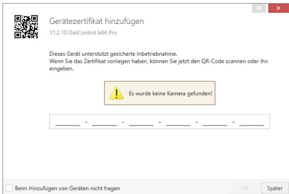
Das Zertifikat besteht aus der Seriennummer und einem Anfangsschlüssel FDSK (Factory Default Setup Key). Dieser Code wird nur für die Erstinbetriebnahme mit der ETS verwendet. Beim ersten Download wird dieser Schlüssel durch die ETS ersetzt. Damit wird verhindert, dass sich Unbefugte trotz Kenntnis des Erstschlüssels Zugang zur Anlage verschaffen können.
