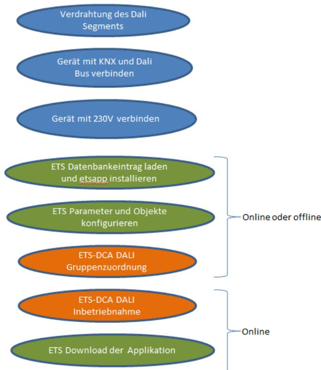
Nach der Verdrahtung des DALI Segmentes gemäß Bedien- und Montageanleitung BMA DCgc16 kann mit der Softwareinbetriebnahme begonnen werden.
