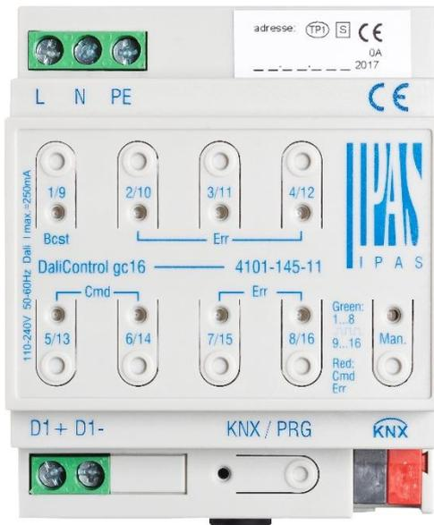
Die Tasten und LEDs sind auch ohne Entfernen der Abdeckung in der Verteilung zugänglich. Im KNX Busbetrieb und bei fehlerfreiem Gateway sind alle 9 LEDs aus. Erkennt das Gateway einen Fehler (z.B. Lampenfehler oder KNX Fehler), blinkt nur die LED in der Man. Taste schnell rot. Läuft im Gerät ein Programmiervorgang (z.B. während eine Neu- oder Nachinstallation durchgeführt wird) blinken alle LEDs (bis auf die Man. Taste) des Gerätes langsam rot.
