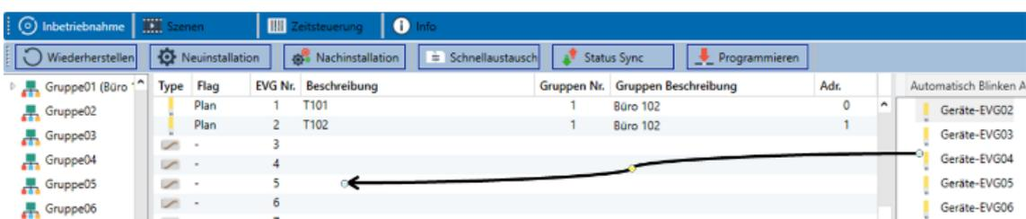
Sobald ein EVG in die EVG Konfigurationstabelle gezogen wurde, verschwindet es aus der Liste der nicht identifizierten EVGs. Gleichzeitig verdeutlicht ein Flag ‚PLAN‘ in der Konfigurationstabelle, dass das EVG dem geplanten Element zugeordnet wurde. In der letzten Spalte der Tabelle wird die reale EVG Kurzadresse eingeblendet. Es ist zu beachten, dass die reale Kurzadresse zwischen 0 und 63 liegt.
