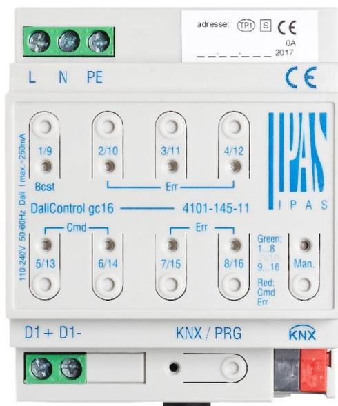
Die Tasten und LEDs sind auch ohne Entfernen der Abdeckung in der Verteilung zugänglich. Im KNX Busbetrieb und bei fehlerfreiem Gateway sind alle 9 LEDs aus. Erkennt das Gateway einen Fehler (z.B. Lampenfehler oder KNX Fehler), blinkt nur die LED in der Man. Taste schnell rot. Läuft im Gerät ein Programmiervorgang (z.B. während eine Neu- oder Nachinstallation durchgeführt wird) blinken alle LEDs (bis auf Man.) des Gerätes langsam rot.
