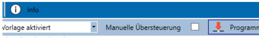
Diese Funktion ist besonders interessant für HCL Steuerungen. Wird die Helligkeit oder Farbe eines Elements (Gruppe / Einzel-EVG) geändert, stoppt der Automatikbetrieb für diese Element. Beim nächsten Aktionszeitpunkt wird dann keine automatische Farbeinstellung ausgeführt. Die Änderung, die durch den Nutzer vorgenommen wurde, bleibt solange erhalten, bis der Automatikbetrieb wieder aktiviert wird.
