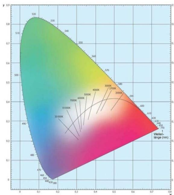
Abbildung 1: Farbraum-Chromatizitäts-Diagramm nach CIE 1931 (Quelle: Wikipedia)
