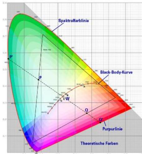
Die Farbe wird hier durch einen Wert XY zwischen 0 und 1 gekennzeichnet. Im KNX wird dieser Wertebereich auf einen Bereich 0..65535 (2 Byte Ganzzahl) umgerechnet. Der Wert 65535 entspricht daher dem Wert 1 in der Grafik.
