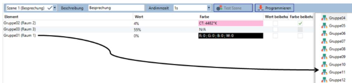
Eine weitere Möglichkeit zum Löschen eines Eintrages befindet sich im Kontextmenü (Rechts Klick in einer Zeile):
