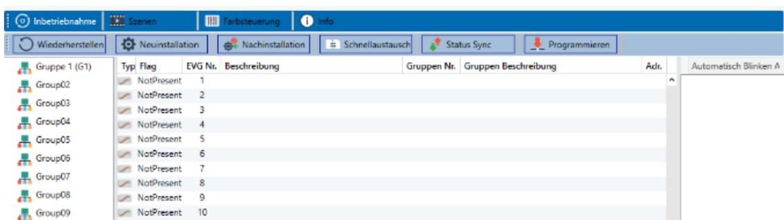
Auf der linken Seite ist in einer Baumstruktur die Gruppenkonfiguration dargestellt. Im mittleren Bereich befindet sich eine tabellarische Darstellung für die EVG Konfiguration und Benennung. Im rechten Bereich findet sich eine Liste mit den real im System gefundenen, noch nicht identifizierten Geräten. In der Planungsphase ist diese zunächst leer, da die ETS nicht mit dem System verbunden ist.
