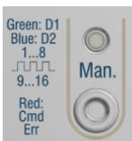
Der Handbetrieb wird automatisch 60 Sekunden nach letzter Tastenbetätigung wieder verlassen.
