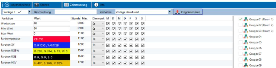
Im mittleren Bereich kann nun eine Liste von Aktionen erstellt werden. Eine Aktion wird zu einem bestimmten Zeitpunkt für alle in der Vorlage ausgewählten Gruppen automatisch ausgeführt. Insgesamt können in einem DALI Gateway in Summe über alle Vorlagen maximal 300 Aktionen hinterlegt werden. Das Erzeugen von Aktionslisten und die Bedienung erfolgt weitestgehend über das Kontextmenü.
